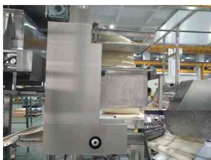
横向叠面机，面带多方向压延，采用大中小波纹辊压延，面条口感好，面条更加Q劲。
