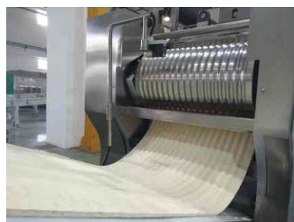
采用面带转向机构，可做不同工艺产品，节约设备一次性投入。
