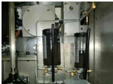
配置集中注油系统,采用定量递给式分配器可确保每一个润滑点都有油注入润滑,保养简单迅速,效率高。
