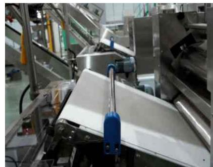
采用1000GS磁力棒,能有效吸附铁质物体以防止铁质物进入切丝刀造成切丝刀损坏。
