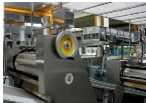
监测面皮压延压力,防止铁钉等金属硬物体,进入辊轮与切丝刀,确保设备及人员安全。
